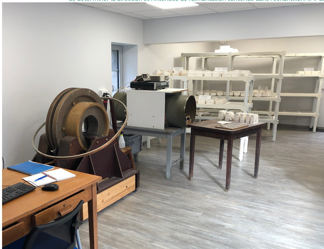
Photographie du laboratoire d'archéomagnétisme. La machine au centre est un inductomètre à rotation qui permet de déterminer la direction et l'intensité de l'aimantation contenue dans l'échantillon. © IPGP
